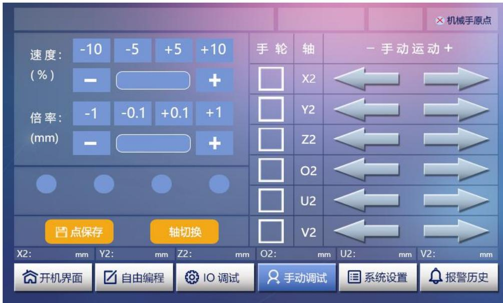
图2-8(b) [手动测试-轴切换]功能界面
