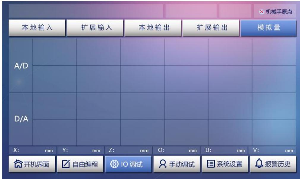
图2-7(e) [IO 调试-模拟量]功能界面
