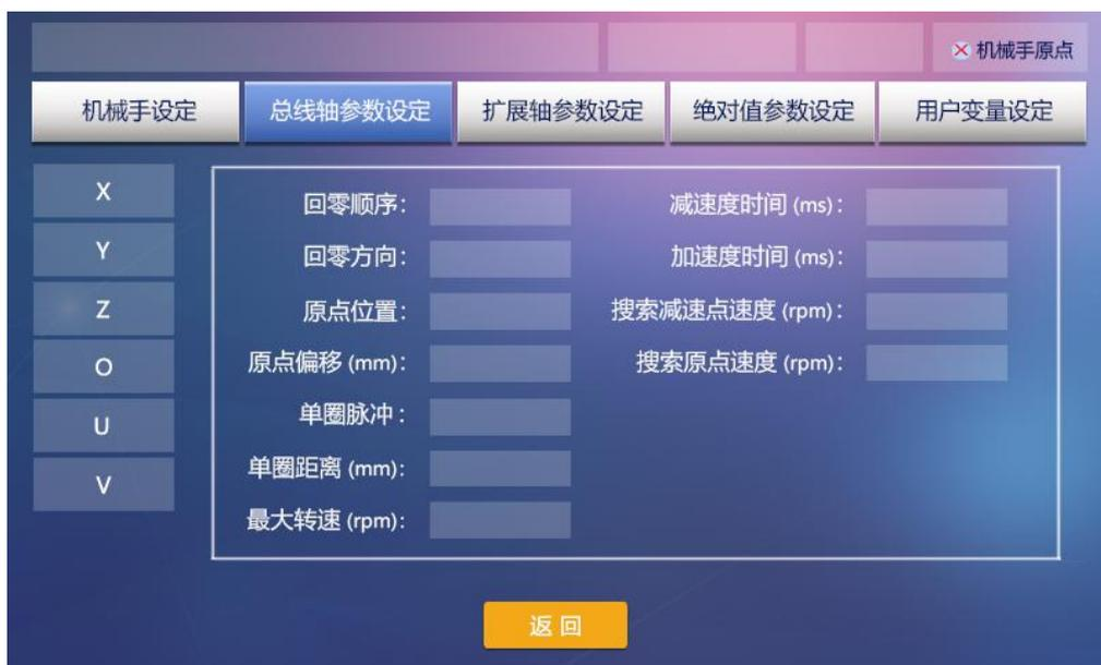
图3-19 [总线轴参数设定]功能界面
